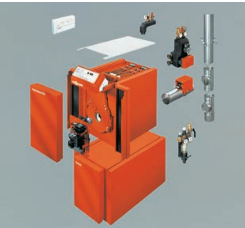
Системотехника от Viessmann: модульная сборка отопительного котла Vitola-RN
