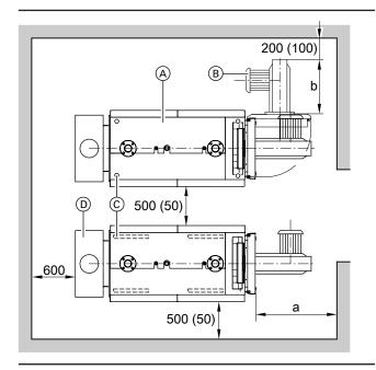
Zur einfachen Montage und Wartung die angegebenen Maße einhalten. Bei beengten Platzverhältnissen müssen nur die Mindestabstände (Maße in Klammern) eingehalten werden. Im Auslieferungszustand ist die Kesseltür nach links ausschwenkbar angebaut. Die Scharnierbolzen können so umgesteckt werden, dass die Tür nach rechts ausschwenkt.
